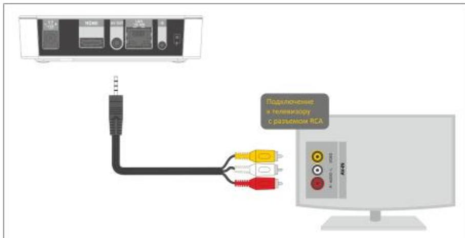
Рисунок 8 – Подключение к телевизору по интерфейсу RCA
