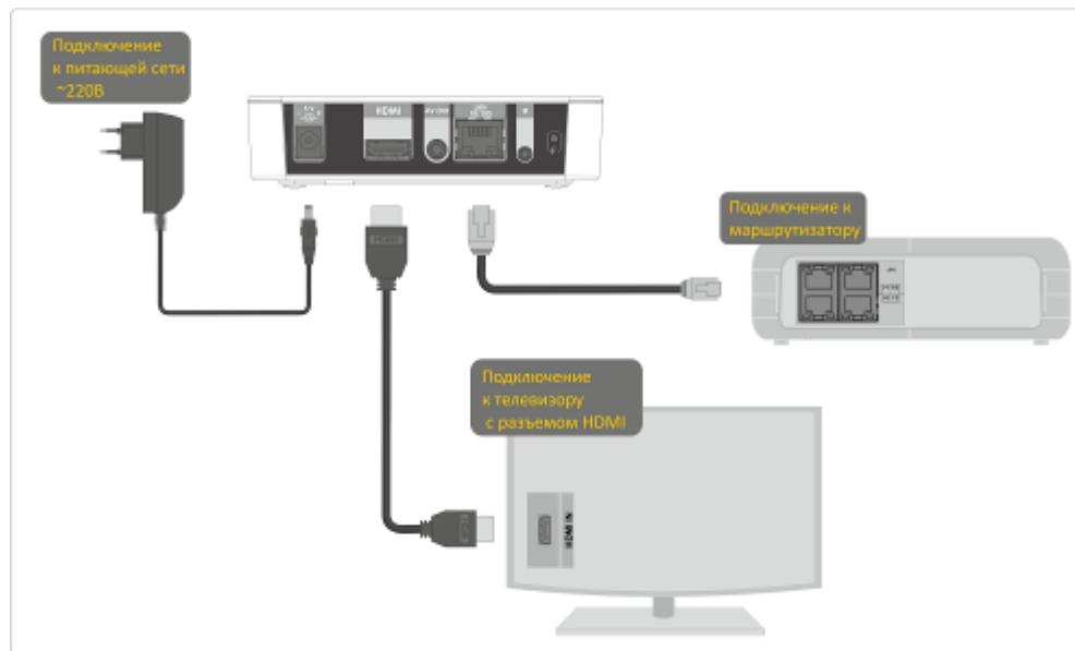
Рисунок 11 – Пример подключения медиацентра NV-300
