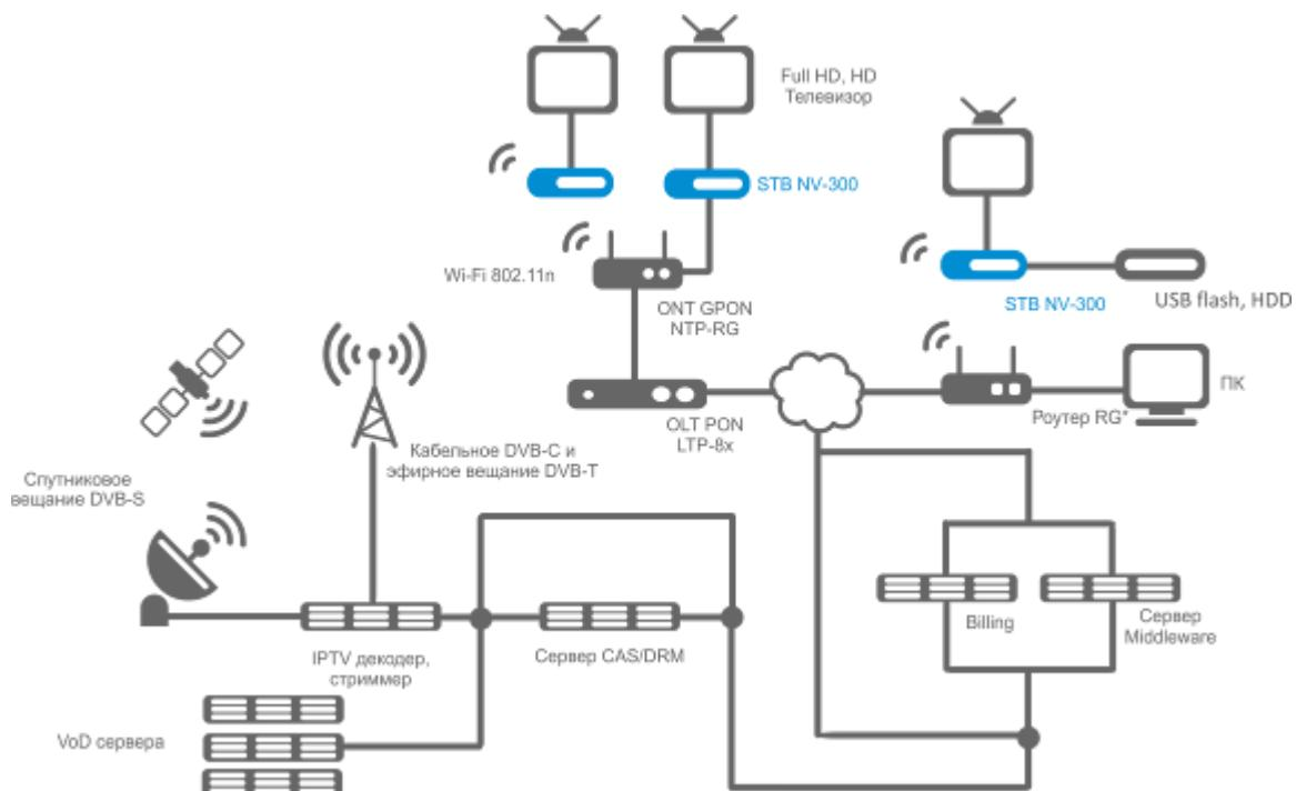
Рисунок 1 – Схема применения
