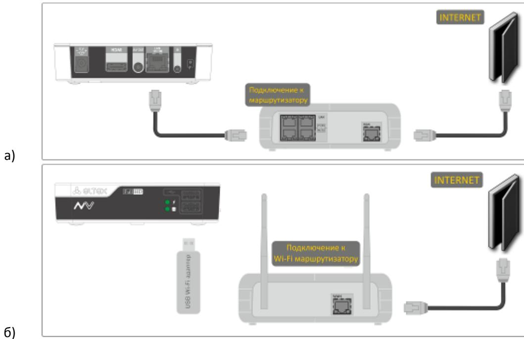
Рисунок 10 – Подключение к сети провайдера, используя маршрутизатор
