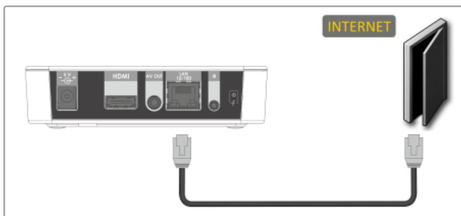
Рисунок 9 – Подключение к сети провайдера без домашнего маршрутизатора
