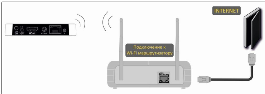
Рисунок 11 – Подключение к сети провайдера, используя Wi-Fi маршрутизатор
